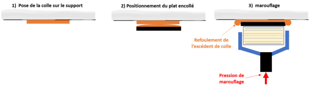
Figure 56 - Double encollage et marouflage d'un plat PRF EBR
