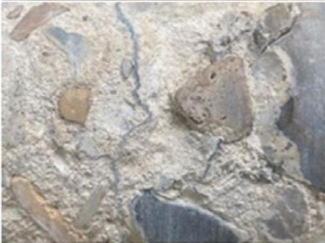
Figure 140 : Carottages de maçonnerie après injection de résine illustrant le comblement de vides centimétriques et infra-millimétriques (crédit photo URETEK).
