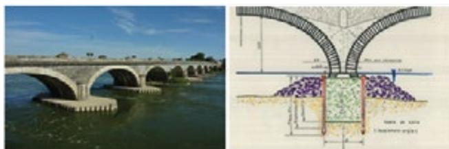
Figure 23 : Fondation sur massif de béton de chaux immergé coulé à l'abri d'un rideau de palplanches bois (terrain inaccessible par épuisement). Pont Dumnacus sur la Loire aux Ponts - de - Cé 1846 -1850 (photo Wikipédia libre de droit et image d'archives)
