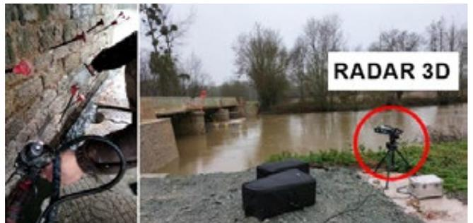
Figure 143 : Contrôle d'injection des piles du Pont de St Maxire (79) (crédit photo URETEK)
