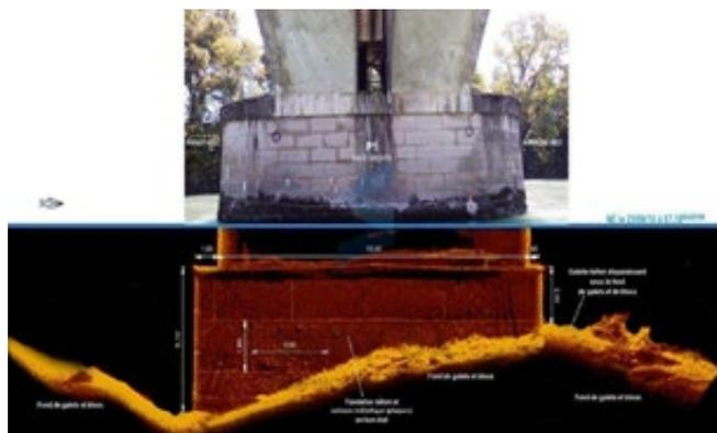
Figure 104 : Exemple d'image obtenue par échosondeur superposée à l'image aérienne de la structure (crédit photo SATIF)
