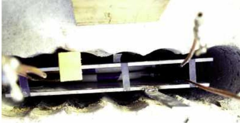
Photo n° 81 : dispositif de vérinage (crédit photo P. Vion)
