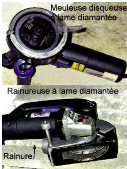
Photo n° 53 : meuleuse disqueuse et rainureuse (crédit photo D. Poineau)
