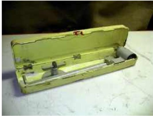
**Photo n° 29 : balance de baroid** (crédit photo Lab X)
