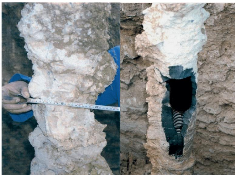
Photo n° 13 : bulbes de boulons d'ancrage déterrés (photos Ischebeck).
