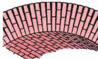
Figure n° 31 : voûtes en briques à rouleaux harpés ou non
