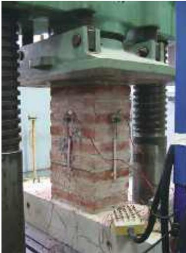
**Photo n° 14 : essais d'un muret de briques**
