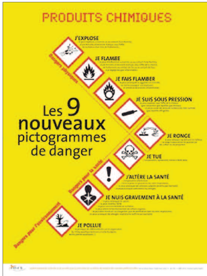
Figure n° 17 : pictogrammes CLP de la nouvelle réglementation sur l'étiquetage extrait d'un document INSROPBTP (crédit photo INSROPBTP)
