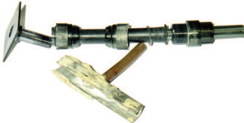
Photo n° 20 : autres types d'injecteurs collés (crédit photo Poineau)
