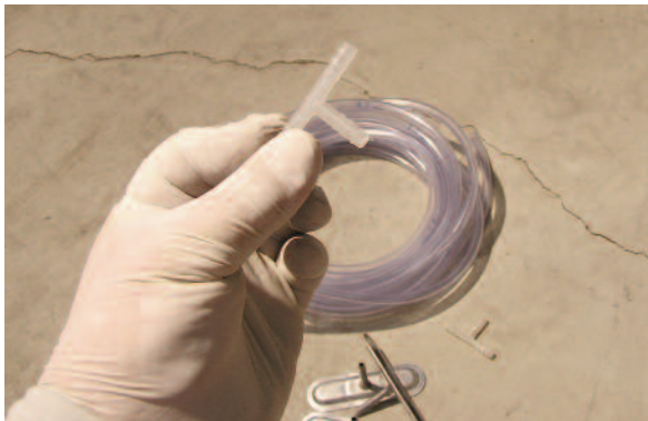
Photo n° 18 : flexible transparent et T de connexion (crédit photo Freyssinet)
