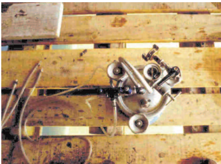
Photo n° 15 : pot à pression et flexible d'injection (crédit photo Freyssinet)
