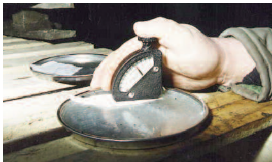
Photo n° 46 : contrôle de la dureté shore d'une résine d'injection (crédit photo Séttra)
