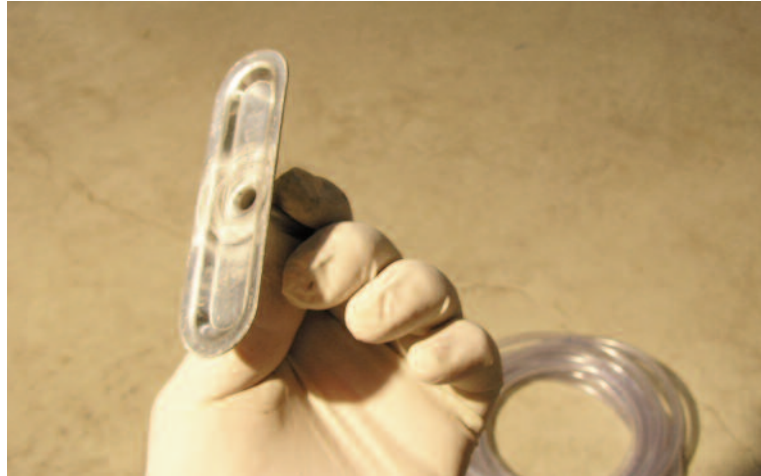
Photo n° 19 : injecteur plat ou cavalier (crédit photo Freyssinet)
