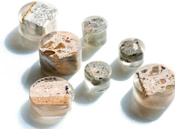
L'identification des granulats par observation de lames minces par microscopie optique en lumière transmise polarisée
