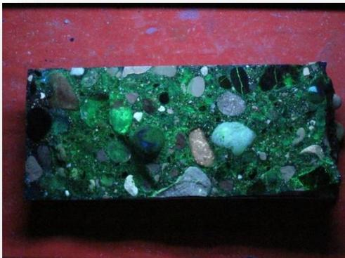
Recherche de gels d'alcali-réaction par fluorescence des ions uranyl
