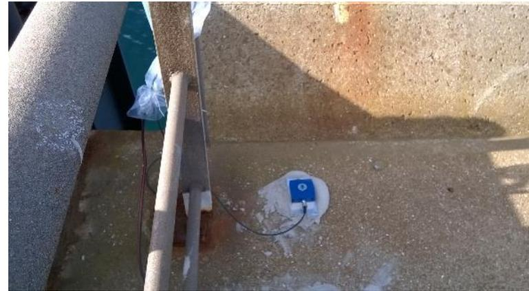
Illustration d'un capteur de vibration, de type géophone triaxiale
