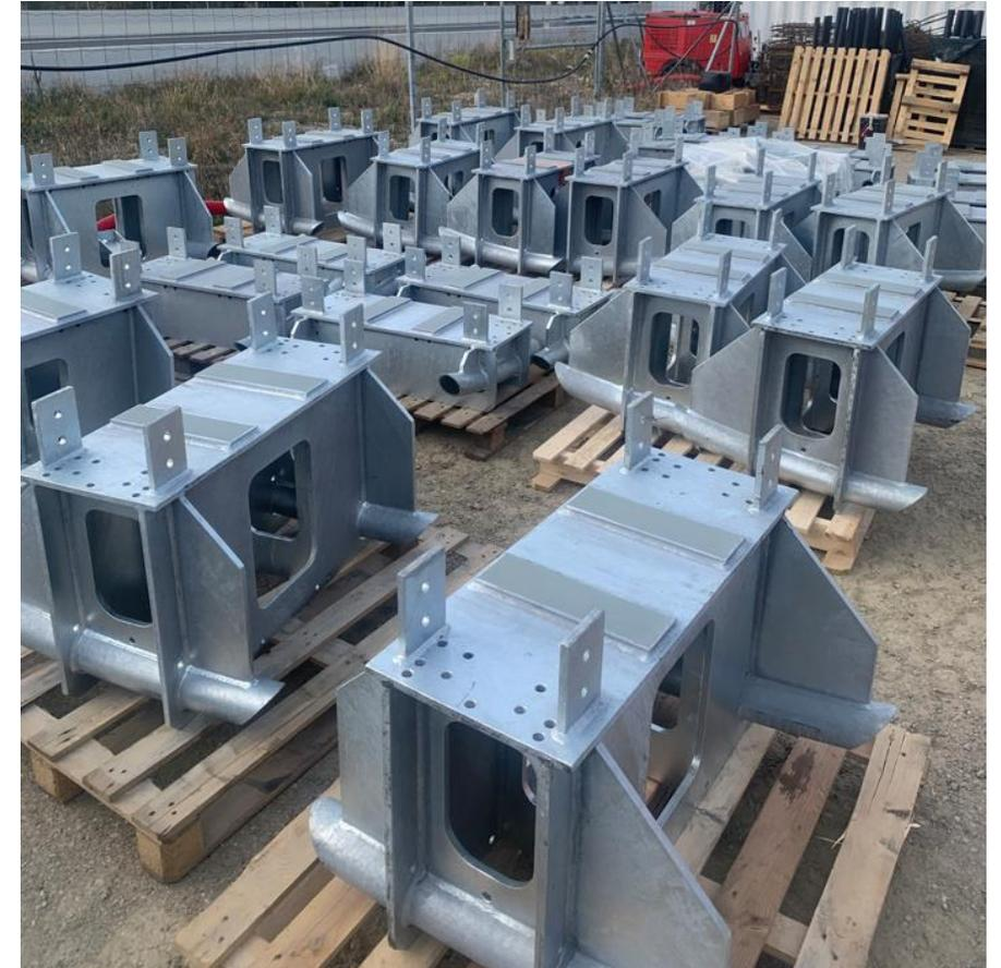
Mise en place d'un gabarit pour éviter la manutention lors du coffrage
