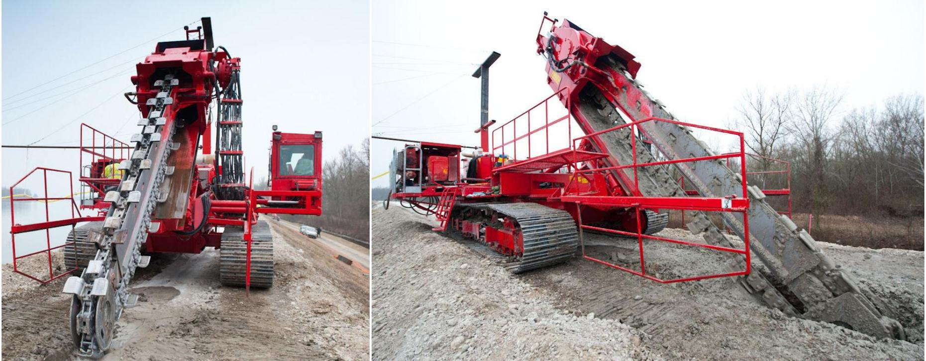
Puissance installée : 450 kW – Masse : 45 tonnes
